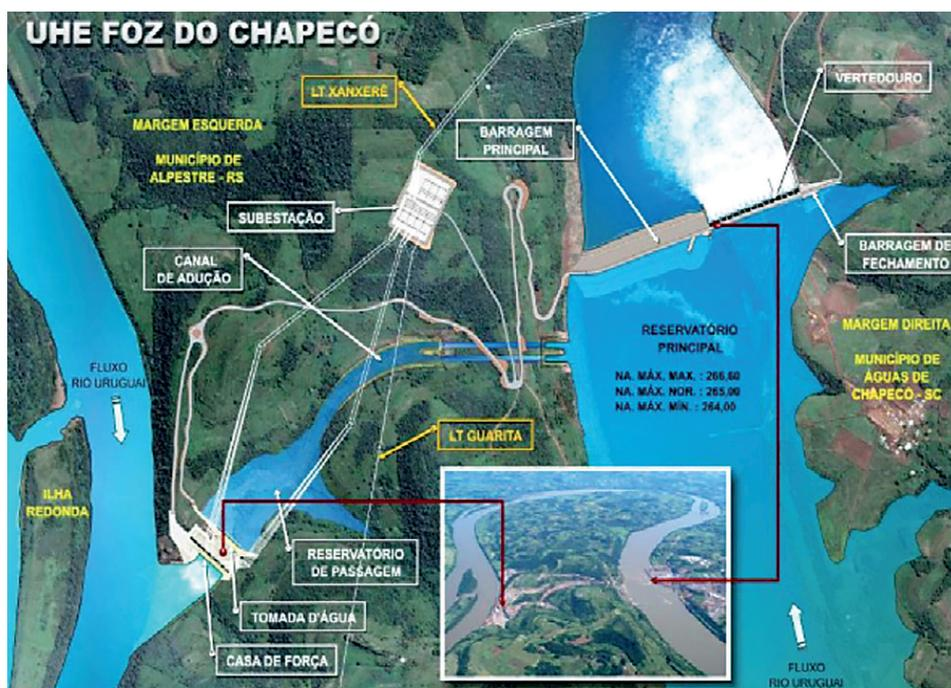
*Figura 50. Vista general de la disposición estructural de la Central hidroeléctrica Foz de Chapecó (Guimaraes, 2011)*
