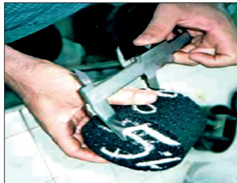
*f: Mediciones de las dimensiones de la probeta de ensayo.*
