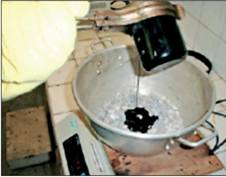
*a: Adición de asfalto a los agregados.*
