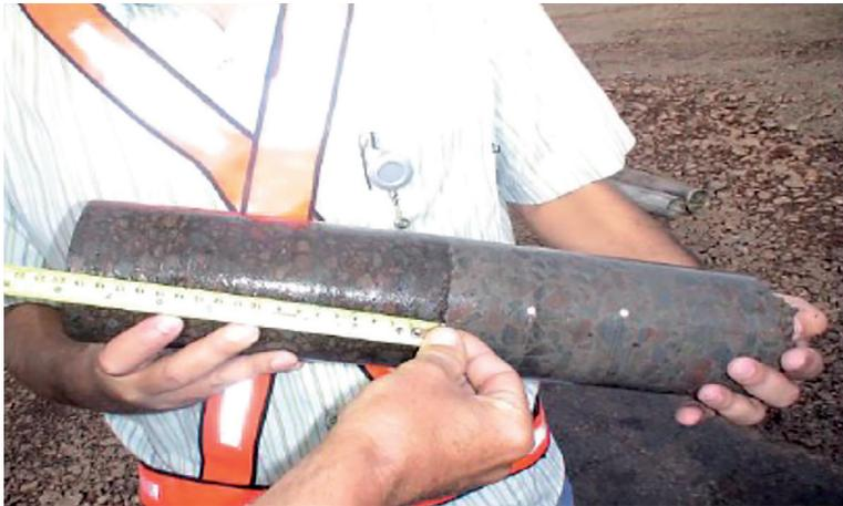
*Figura 67. Medición de muestras de concreto asfáltico de capas compactadas.*
