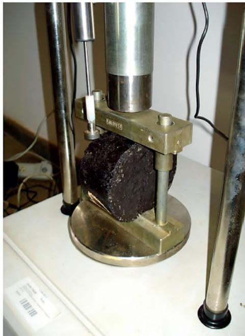
*Figura 37. Ensayo de resistencia a la compresión de tracción simple (Lobo de Carneiro, 1953).*
