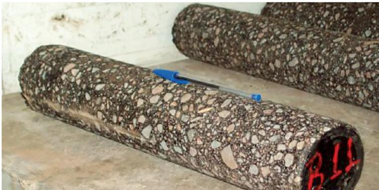
*Figura 68. Muestras extraídas para la evaluación experimental de sus propiedades.*
