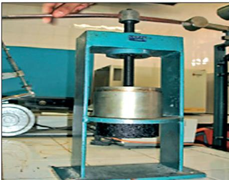
*e: Extracción de la probeta del molde.*
